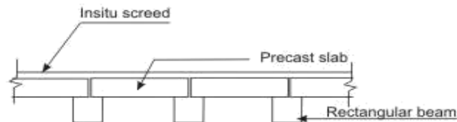
Fig. 5.10.1(c) Precast slab on rectangular beams
